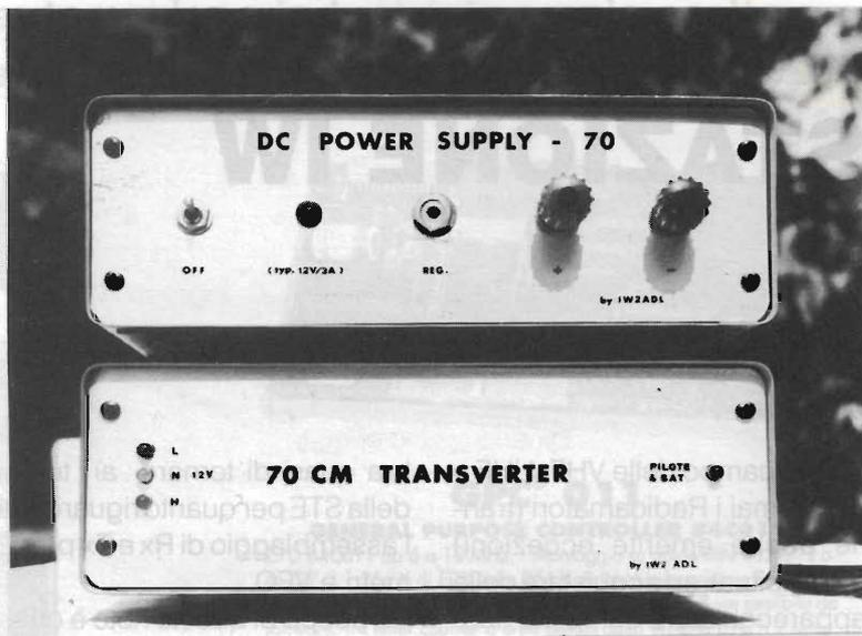
dei bocchettoni e delle relative pagliette di massa. Nella foto si vede l'aggiunta di un indicatore visivo (a tre LED) di livello della tensione di alimentazione, nel
